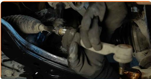
**13** Limpie los asientos de montaje del extremo de la barra de acoplamiento. Use un cepillo de alambre. Use el aerosol WD-40.
