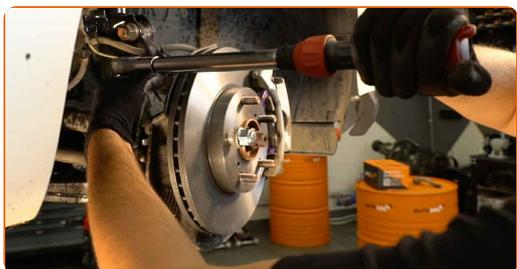
**19** Instale el pasador de sujeción. Use una palanca.
