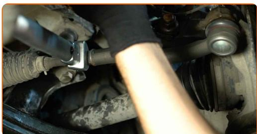
**21** Trate la sujeción que conecta el extremo de la barra de acoplamiento a la mangueta de dirección. Use grasa de cobre.
