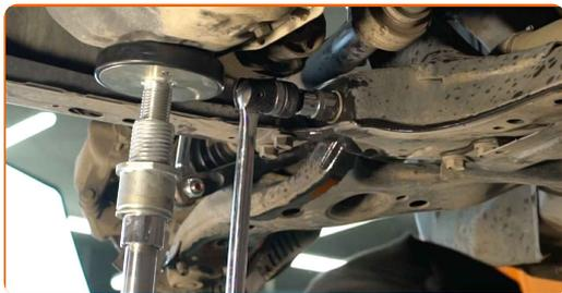
**19** Retire la sujeción delantera del brazo de control.
