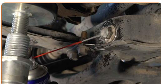
**18** Destornille la fijación delantera de la palanca. Use un vaso de impacto del n.º 22. Utilice una llave giramachos.
