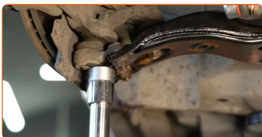
**33** Apriete la sujeción delantera que conecta el brazo de control al subchasis. Use un vaso de impacto del n.º 22. Utilice una llave dinamométrica. Apriételo a un par de 233 Nm.
