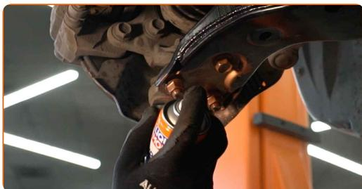
**41** Trate la superficie donde el disco del freno entra en contacto con la llanta de la rueda. Use grasa de cobre.
