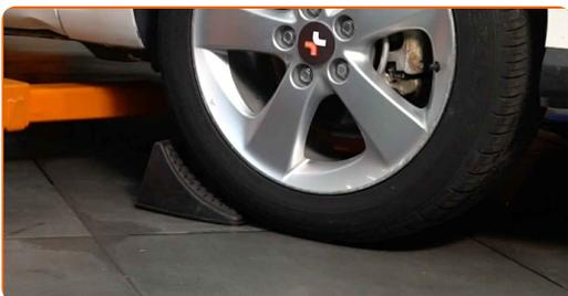
**4** Afloje los pernos de fijación de la rueda. Utilice una llave de impacto para llanta # 21.
