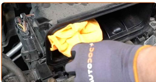
**35** Conecte el tubo de entrada de aire a la carcasa del filtro de aire.
