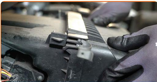
**37** Presione los clips de la cubierta del filtro de aire en su lugar.
