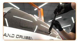
Presione el clip de fijación. Utilice un destornillador plano.
