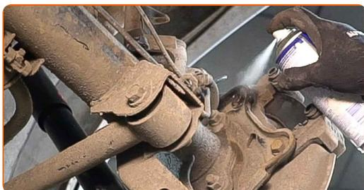
**13** Destornille la fijación de la pinza del cáliper de freno. Use un vaso de impacto del n.º 17. Utilice una llave giramachos.
