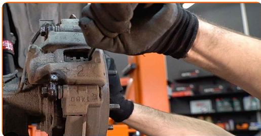
**9** Destornille la fijación del cáliper de freno. Use un vaso de impacto del n.º 17. Utilice una llave giramachos.
