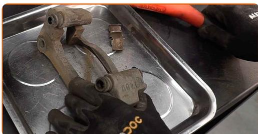
**21** Instale la pinza del cáliper de freno.
