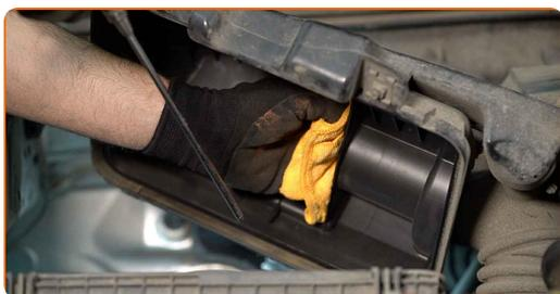
Sustitución: filtros de aire - TOYOTA LAND CRUISER 150 (KDJ15\_, GRJ15\_).
