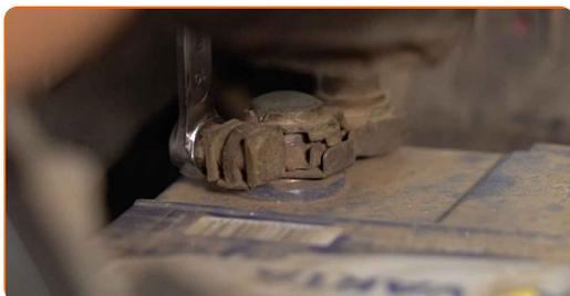
**4** Retire los terminales de la batería.
