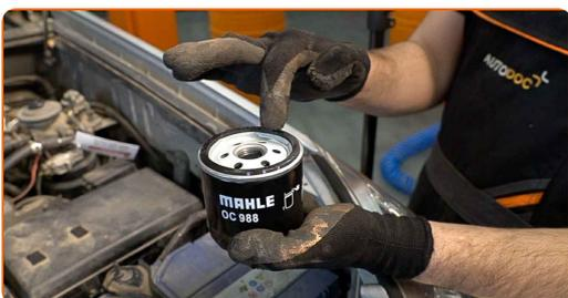
**19** Atornille el filtro nuevo en su sitio. Utilice el vaso 76-14F. Utilice una llave dinamométrica. Apriételo a un par de 20 Nm.
