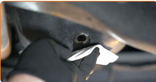
**15** Atornille en el nuevo tapón de drenaje y apriételo. Use un vaso de impacto del n.º 15. Utilice una llave dinamométrica. Apriételo a un par de torsión de 27 Nm.
