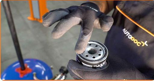
**13** Atornille el filtro nuevo en su sitio. Utilice el vaso 76/14-F. Utilice una llave dinamométrica. Apriételo a un par de torsión de 23 Nm.
