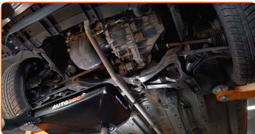
6 Destornille el tapón de desagüe. Use un vaso de impacto del n.º 15. Utilice una llave de trinquete.
