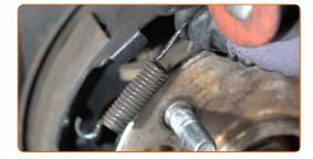
Trate las sujeciones del cojinete del cubo de rueda. Use el aerosol WD-40.
