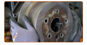
Retire el muelle de la zapata de freno izquierda del freno de estacionamiento. Utilice unos alicates de nariz larga. Use una palanca.
