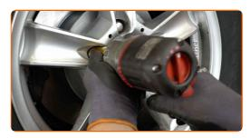
Baje el automóvil y, manteniendo el orden cruzado, apriete los pernos de fijación de las ruedas. Utilice una llave de impacto para llanta # 19. Utilice una llave dinamométrica. Apriételo a un par de 103 Nm.
