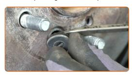
Suelte el ajustador del freno de mano. Utilice un destornillador plano.
