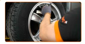
6 Retire el pasador de sujeción. Use una palanca.
