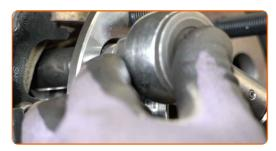
Atornille la sujeción del eje CV. Use un vaso de impacto del n.º 30. Utilice una llave de trinquete.
