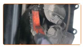
Desenrosque las sujeciones de la pinza de freno. Use un vaso de impacto del n.º 14. Utilice una llave de trinquete.
