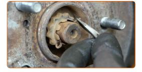
Retire el anillo de retención del cojinete del cubo de rueda. Use una palanca.
