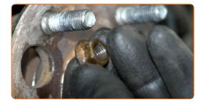
Desenrosque la fijación que conecta el eje de transmisión al cubo de la rueda. Use un vaso de impacto del n.º 30. Utilice una llave de trinquete.
