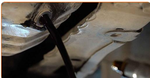
Sustitución: aceite de motor y filtro - TOYOTA PREVIA (MCR3\_, ACR3\_, CLR3\_).
