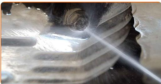
**8** Coloque un contenedor para el aceite de desecho con al menos 5 l de capacidad debajo del orificio de drenaje.
