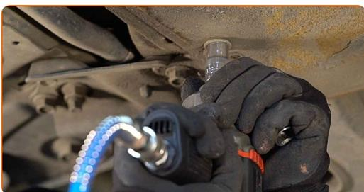
**6** Retire la cubierta del cárter de aceite.
