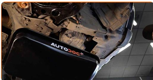
**9** Destornille el tapón de desagüe. Use un vaso de impacto del n.º 15. Utilice una llave de trinquete.
