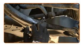
Desatornille la sujeción que conecta la bieleta de barra estabilizadora al amortiguador. Usa una llave mixta del n.º 17. Use un vaso de impacto del n.º 17. Utilice una llave de trinquete.
