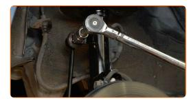
Apriete la sujeción que conecta la bieleta a la barra estabilizadora. Use un vaso de impacto del n.º 19. Utilice una llave dinamométrica. Apriételo a un par de 74 Nm.
