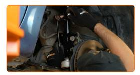
Apriete la sujeción que conecta la bieleta de barra estabilizadora al amortiguador. Use un vaso de impacto del n.º 19. Utilice una llave dinamométrica. Apriételo a un par de 74 Nm.
