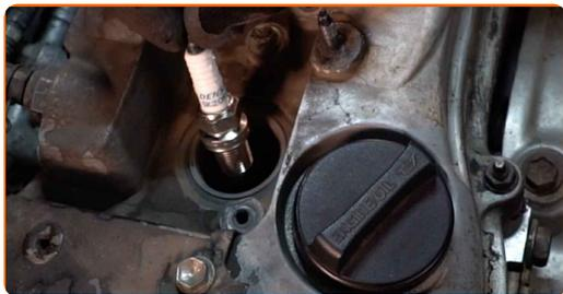
**14** Atornille las bujías nuevas y apriételas. Use el vaso de bujía # 16. Utilice una llave dinamométrica. Apriételo a un par de 25 Nm.
