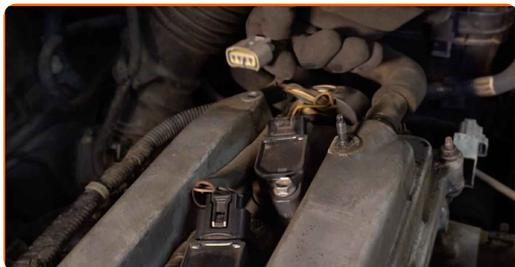
**6** Destornille la atadura de la bobina del encendido. Use un vaso de impacto del n.º 10.
