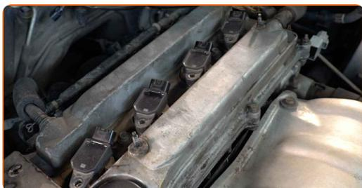
**8** Saque la bobina de ignición del pozo de la bujía.
