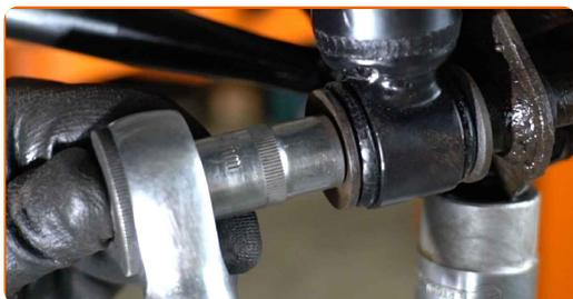
**23** Trate el elemento de sujeción inferior del amortiguador. Use grasa de cobre.
