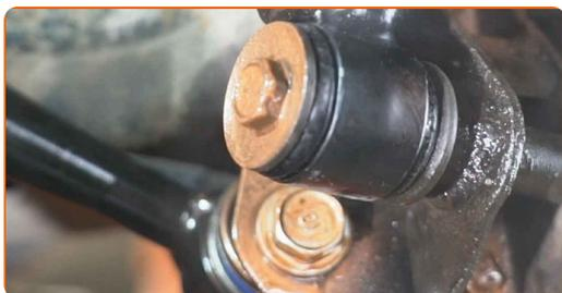
**24** Instale los elementos del soporte superior del amortiguador.
