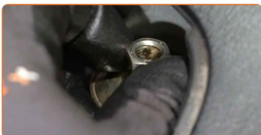
**15** Retire los elementos del soporte superior del amortiguador.
