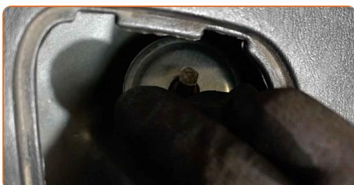
**25** Atornille la sujeción superior del amortiguador.
