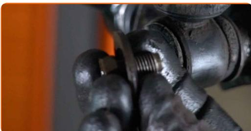
**13** Apoye la mangueta trasera. Utilice un gato de transmisión hidráulica.
