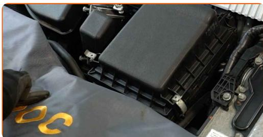
**13** Fije la abrazadera en el manguito de admisión de aire. Use un vaso de impacto del n.º 10. Utilice una llave de trinquete.
