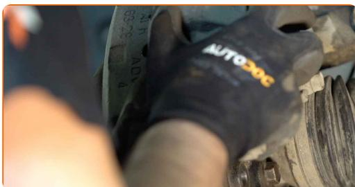
**39** Apriete la fijación de la pinza del cáliber de freno. Use un vaso de impacto del n.º 18. Utilice una llave dinamométrica. Apriételo a un par de 98 Nm.
