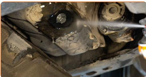
**26** Vuelva a instalar la cubierta inferior del cárter de aceite.
