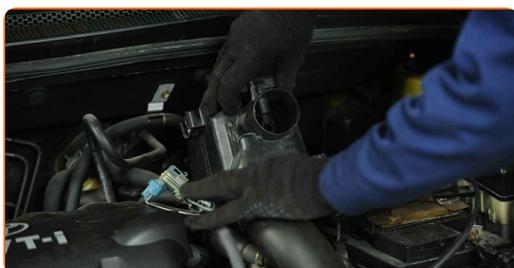
**12** Bloquee los clips de retención de la cubierta de la carcasa del filtro de aire.
