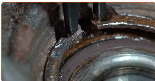
**40** Desmonte el anillo de rodamiento interior que queda en el cubo. Utilice un juego de cubos y rodamientos. Utilice un separador de rodamientos.
