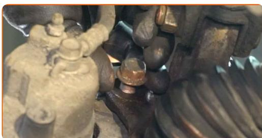
**72** Apriete las sujeciones del soporte de la pinza de freno. Use un vaso de impacto del n.º 17. Utilice una llave dinamométrica. Apriételo a un par de 107 Nm.
