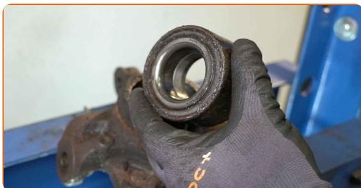
**42** Limpie el asiento de montaje del cojinete del cubo (bujete). Use un cepillo de alambre. Use el aerosol WD-40.
