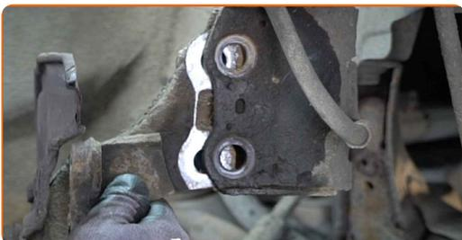
**33** Retire la mangueta de dirección junto con el cubo de rueda.
