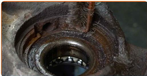
**39** Retire el anillo de retención del cojinete del cubo de rueda. Utilice alicates para arandelas.
