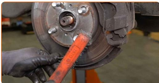
**74** Trate la superficie donde el disco del freno entra en contacto con la llanta de la rueda. Utilice grasa cerámica.
