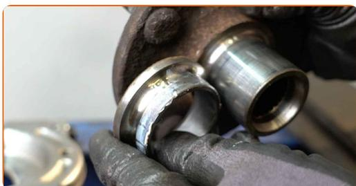
**41** Presione para extraer el cojinete del cubo de rueda. Utilice un juego de cubos y rodamientos.
