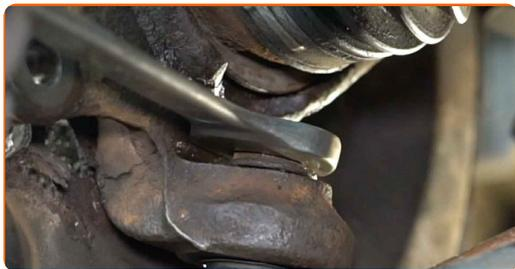
**56** Apriete la sujeción que conecta la rótula a la mangueta de dirección. Usa una llave mixta del n.º 19. Utilice una llave dinamométrica. Apriételo a un par de 65 Nm.
