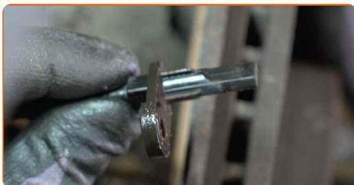
**17** Desenrosque la fijación que conecta el eje de transmisión al cubo de la rueda. Utilice un vaso 12 puntos nº 30. Utilice una llave de trinquete.
