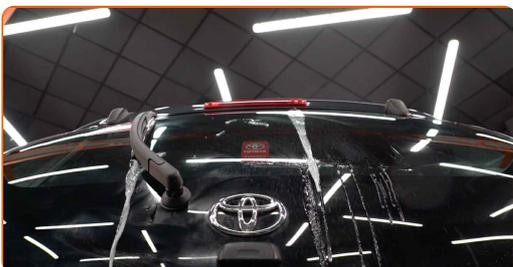
**6** Después de la instalación verifique el funcionamiento del limpiaparabrisas.
