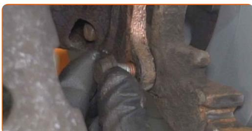
**23** Apriete las sujeciones del soporte de la pinza de freno. Use un vaso de impacto del n.º 14. Utilice una llave dinamométrica. Apriételo a un par de 57 Nm.
