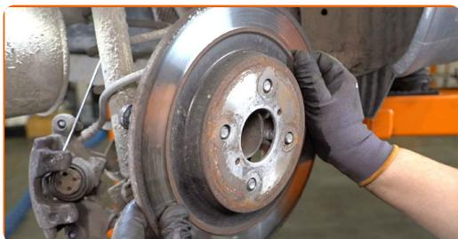
**17** Limpie la sujeción del sensor ABS. Utilice un cepillo de limpieza de nylon. Utilice un spray de limpieza multiuso.
