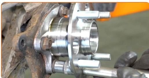
**29** Trate los sujetadores del cojinete del cubo de la rueda. Use grasa de cobre.
