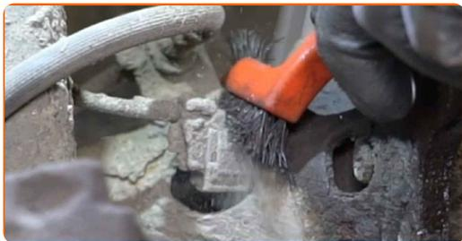
**18** Suelte el conector del sensor ABS. Utilice un destornillador plano.
