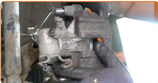
**42** Apriete las sujeciones de la pinza del freno. Use Vaso HEX No. H7. Utilice una llave dinamométrica. Apriételo a un par de 34 Nm.
