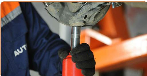
**16** Apriete la sujeción que conecta la bieleta a la barra estabilizadora. Usa una llave mixta del n.º 13. Use un vaso de impacto del n.º 13. Utilice una llave dinamométrica. Apriételo a un par de 18 Nm.
