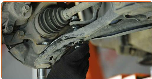
**17.2** Usa una llave mixta del n.º 13. Use un vaso de impacto del n.º 13. Utilice una llave dinamométrica. Apriételo a un par de 18 Nm.
