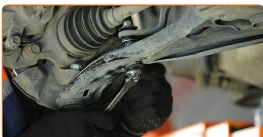
**18** Trate todas las juntas de la bieleta o enlace estabilizador. Use grasa de cobre.
