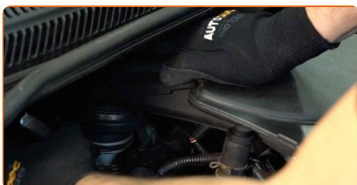
**7** Cubra el cuerpo del acelerador con una toalla de microfibra para evitar que el polvo y la suciedad penetren en el sistema.
