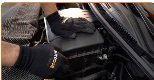
**15** Instale las abrazaderas de sujeción del tubo del respiradero del filtro de aire y del tubo de admisión del filtro de aire. Utilice alicates para abrazaderas de manguera con retenedor.
