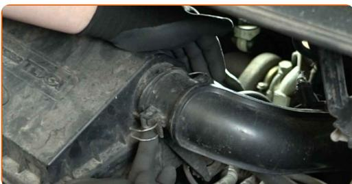
**4** Desconecte la manguera de admisión de aire de la carcasa del filtro de aire.
