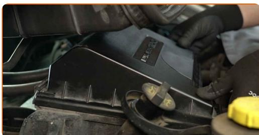
**12** Encaje en su lugar los clips de la cubierta del filtro de aire.
