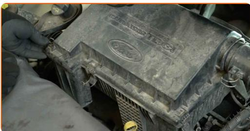
**6** Retire la cubierta del filtro de aire.
