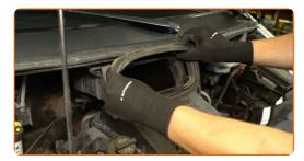
Instale un filtro nuevo en la carcasa. Compruebe las marcas presentes en el borde del filtro para asegurarse de que lo está instalando con el lado correcto hacia arriba.
