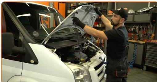
2 Utilice una funda de protección para guardabarros con el fin de evitar daños en la pintura y en las piezas de plástico del coche.
