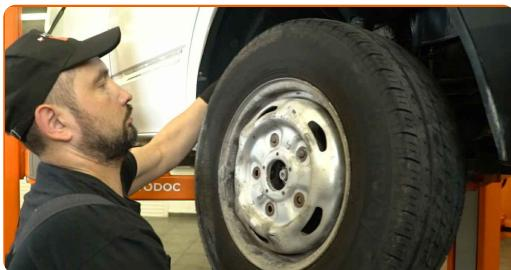
**6** Limpie las sujeciones de una de las bieletas de la barra estabilizadora. Utilice un cepillo de alambre. Utilice el spray WD-40.
