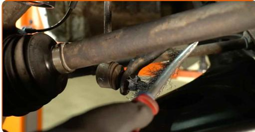
**7** Desenrosque la sujeción que conecta la bieleta de la barra estabilizadora a la barra estabilizadora. Utilice una llave combinada de 19 mm. Utilice una llave Allen H5 para fijar de forma segura el perno esférico. Utilice una llave de carraca.
