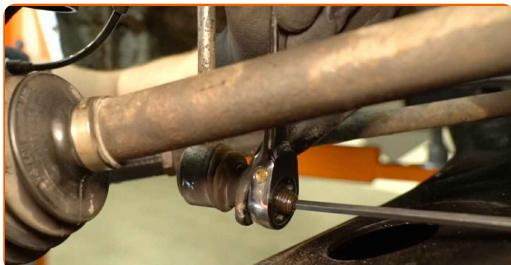
**8** Desenrosque la sujeción que conecta la bieleta de la barra estabilizadora al puntal de suspensión. Utilice una llave de vaso de 19 mm. Utilice una llave de carraca.
