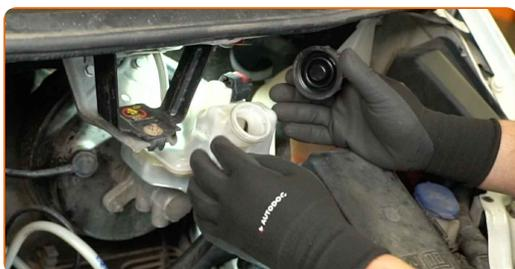
**78** Apriete el tapón del depósito del líquido de frenos.
