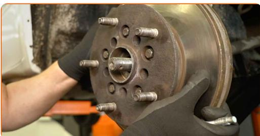
**33** Limpie el asiento de montaje del rodamiento de rueda. Utilice un cepillo de alambre. Utilice un spray limpiador multiusos.
