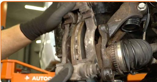
**30** Desenrosque las sujeciones del rodamiento de rueda. Utilice una punta Torx T50. Utilice una llave de carraca.
