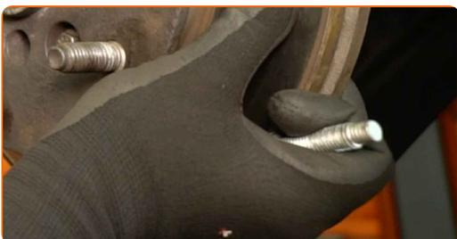
**32** Retire el cubo de rueda junto con el disco de freno.
