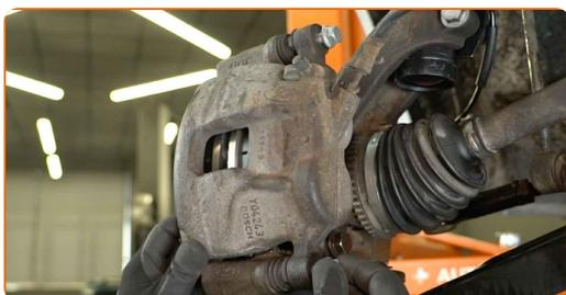
**62** Apriete las sujeciones de la pinza de freno. Utilice una llave combinada de 21 mm. Utilice una llave de vaso de 15 mm. Utilice una llave dinamométrica. Par de apriete: 60 N·m.
