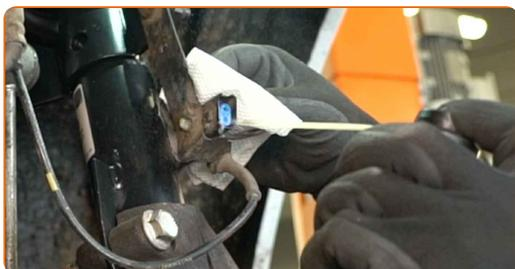
**58** Una el conector del sensor de desgaste de las pastillas de freno.
