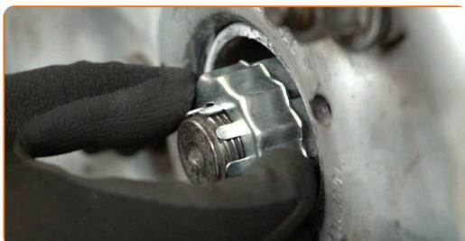
**74** Instale el pasador de chaveta. Utilice una palanca de montaje.
