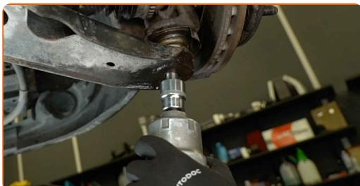
**8** Levante la mancueta de dirección por medio de un gato. Utilice un gato para transmisión o un gato para vehículos adicional.
