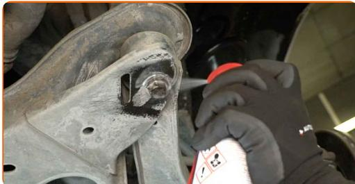
**7** Desenrosque la sujeción que conecta la rótula con el brazo de suspensión. Utilice una llave de vaso de 24 mm. Utilice una llave de carraca.
