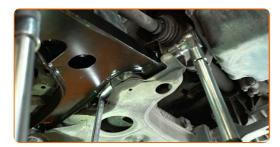
Limpie el asiento de montaje de la llanta. Utilice un cepillo de alambre. Utilice un spray limpiador multiusos.
