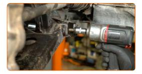
Retire el perno de sujeción.
