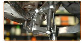
Retire el apoyo de debajo de la mangueta de dirección.
