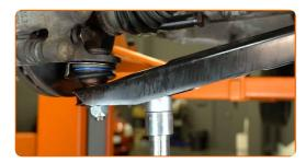
Apriete la sujeción delantera del brazo de suspensión. Utilice una llave combinada de 21 mm. Utilice una llave de vaso de 18 mm. Utilice una llave dinamométrica. Par de apriete: 200 N·m.
