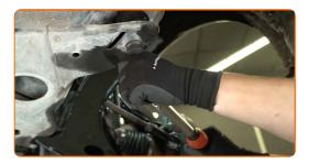
Para apretar correctamente los elementos de sujeción, debe levantar la suspensión mediante un gato, para así cargarla. Utilice un gato para transmisión o un gato para vehículos adicional.
