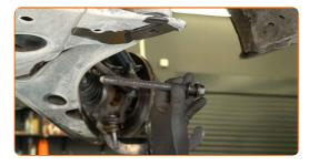
Desenrosque la sujeción delantera del brazo de suspensión. Utilice una llave combinada de 21 mm. Utilice una llave de vaso de 18 mm. Utilice una llave de carraca.
