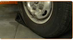
Afloje las tuercas de la rueda. Utilice un vaso de impacto para ruedas de 21 mm. Utilice una llave giramachos con mango en T.
