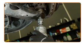
Levante la mangueta de dirección por medio de un gato. Utilice un gato para transmisión o un gato para vehículos adicional.
