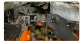
Retire el brazo de suspensión. Utilice una palanca de montaje.
