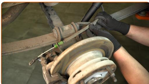
**13** Separe el cable del freno de mano del soporte de la pinza de freno. Utilice unos alicates de punta larga.
