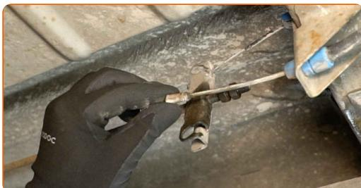
**10** Limpie los puntos de conexión donde el cable del freno de mano se une a la palanca del actuador del freno de mano en la pinza de freno, al soporte en la pinza de freno y al soporte en la ballesta. Utilice un cepillo de alambre. Utilice un spray limpiador multiusos.
