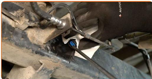
**19** Una el conector del sensor de desgaste de las pastillas de freno.
