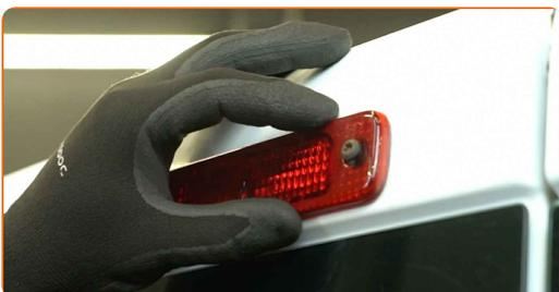
**9** Apriete los tornillos de sujeción de la tercera luz de freno. Utilice una punta Torx T25. Utilice un destornillador de carraca
