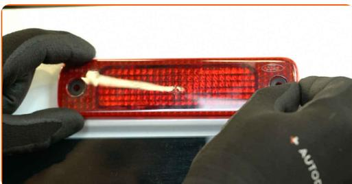
**8** Instale los tornillos de sujeción.
