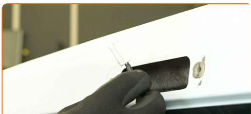
**5** Trate el conector que corresponde a la luz de freno. Utilice un spray para contactos eléctricos.
