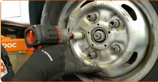
**22** Baje el coche y apriete las tuercas de la rueda siguiendo un orden entrecruzado. Utilice un vaso de impacto para ruedas de 21 mm. Utilice una llave dinamométrica. Par de apriete: 200 N·m.
