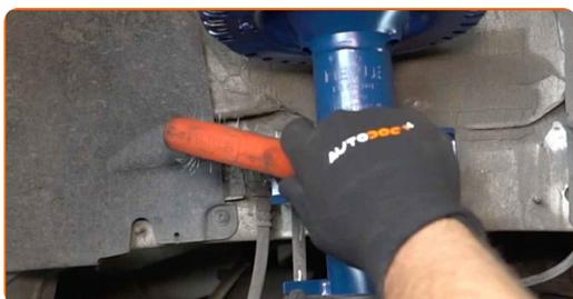
**7** Desatornille la sujeción que conecta la bieleta de barra estabilizadora al amortiguador. Use un vaso de impacto del n.º 18. Utilice una llave de trinquete.
