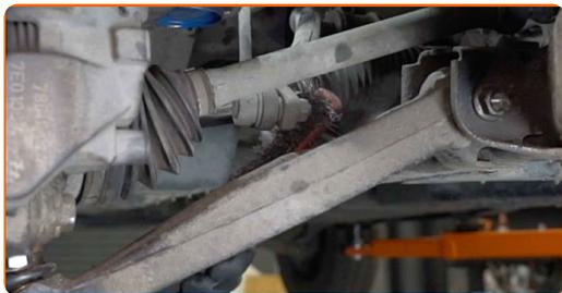
**9** Desatornille la sujeción que conecta la bieleta a la barra estabilizadora. Use un vaso de impacto del n.º 18. Utilice una llave de trinquete.
