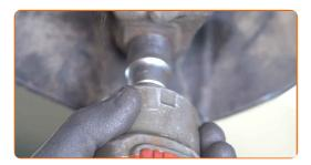
Destornille la fijación delantera de la palanca. Usa una llave mixta del n.º 21.
