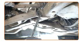
Desatornille la sujeción trasera que conecta el brazo de control al subchasis. Usa una llave mixta del n.º 21.
