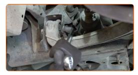
Apriete la sujeción delantera que conecta el brazo de control al subchasis. Usa una llave mixta del n.º 21. Utilice una llave dinamométrica. Apriételo a un par de 110 Nm.+120°
