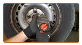
Baje el automóvil y, manteniendo el orden cruzado, apriete los pernos de fijación de las ruedas. Utilice una llave de impacto para llanta # 19. Utilice una llave dinamométrica. Apriételo a un par de 180 Nm.
