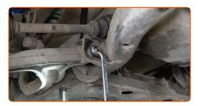
Atornille la sujeción trasera que conecta el brazo de control al subchasis. Usa una llave mixta del n.º 21.
