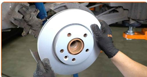
**21** Atornille la sujeción del disco de freno. Utilice las puntas XZN #10. Utilice una llave de trinquete.
