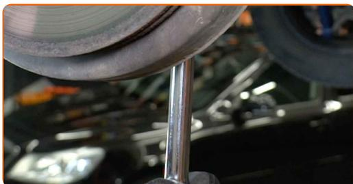
**16** Apriete la fijación superior del amortiguador. Use un vaso de impacto del n.º 18. Utilice una llave dinamométrica. Apriételo a un par de 80 Nm.+90°
