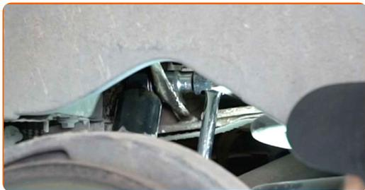
**9** Destornille la fijación inferior del amortiguador. Usa una llave mixta del n.º 21. Use un vaso de impacto del n.º 21. Utilice una llave de trinquete.
