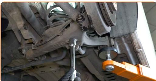
**8** Destornille la fijación superior del amortiguador. Use un vaso de impacto del n.º 18. Utilice una llave de trinquete.
