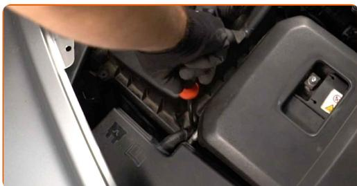
**13** Enchufe el conector del sensor de flujo de aire.
