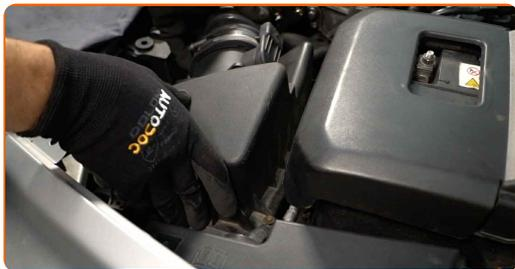
**12** Atornille los tornillos de sujeción de la cubierta del filtro de aire. Utilice un destornillador Phillips.
