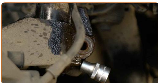
**27** Desconecte el muñón de dirección de la pata amortiguadora.
