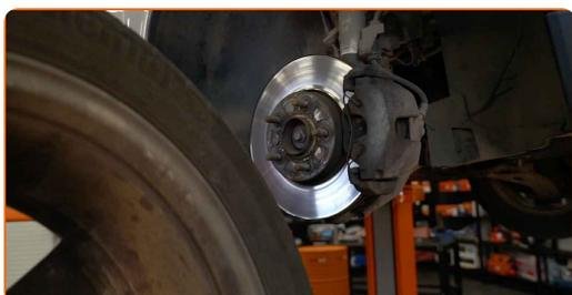
**11** Retire el perno de sujeción.
