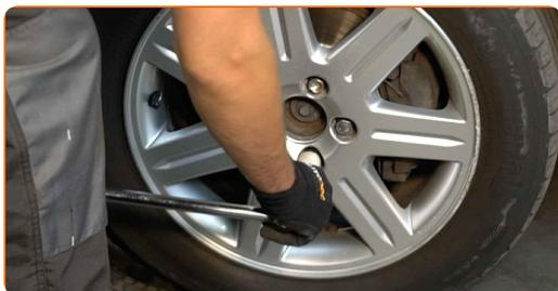
**7** Afloje la sujeción del eje de transmisión. Use un vaso de impacto del n.º 13. Utilice una llave giramachos.
