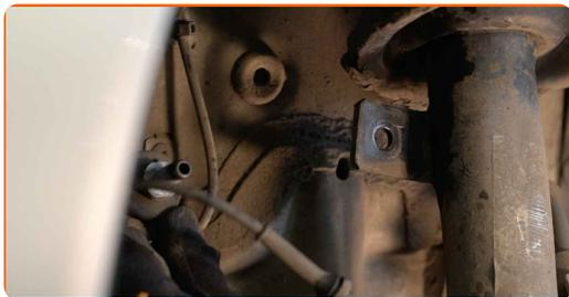
**16** Separe el latiguillo de freno del puntal amortiguador. Use una palanca.
