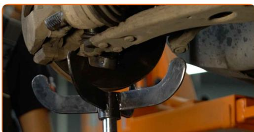
**25** Suelte la sujeción inferior que conecta el puntal amortiguador a la mangueta de dirección. Utilice un vaso de impacto especial para extraer el amortiguador. Utilice una llave de trinquete.
