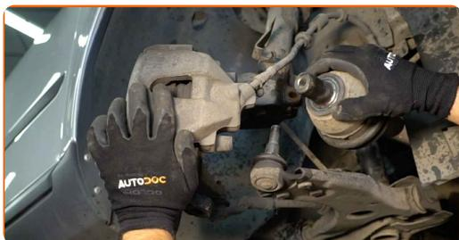
**24** Sostenga el muñón de dirección. Utilice un gato de transmisión hidráulica.
