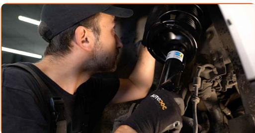
**45** Atornillen la fijación superior de la cazoleta de la pata amortiguadora. No lo apriete.
