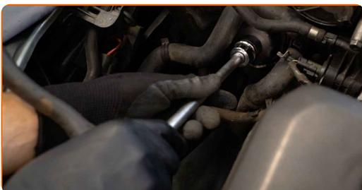
**32** Atornille la tapa. Use un vaso de impacto del n.º 27. Utilice una llave dinamométrica. Apriételo a un par de 25 Nm.
