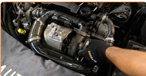
**10** Retire el resorte de retención de la carcasa del filtro de aire.
