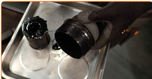
**25** Retire la junta tórica de la tapa del filtro de aceite. Utilice un destornillador plano.
