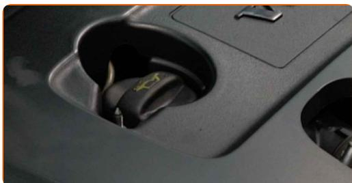
**55** Pongan en marcha el motor por unos minutos. Después de que se apague la luz de advertencia de presión del aceite, detenga el motor.
