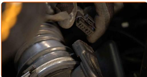
**6** Suelte la abrazadera del manguito de admisión de aire. Use un vaso de impacto del n.º 7. Utilice una llave de trinquete.
