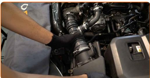
**35** Conecte el tubo de admisión de aire al turbocompresor.
