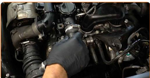
**37** Instale la abrazadera del manguito de ventilación del cárter.
