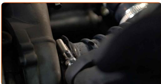
**8** Retire el manguito de ventilación del cárter.
