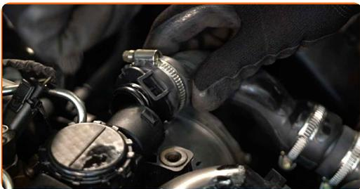
**9** Desconecte el tubo de admisión de aire del turbocompresor.
