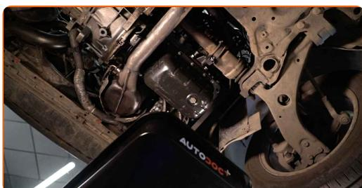
**18** Destornille el tapón de desagüe. Use un vaso de impacto del n.º 21. Utilice una llave de trinquete.
