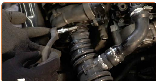
**7** Suelte la abrazadera del manguito de ventilación del cárter.
