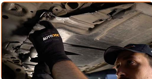
**16** Retire la cubierta del cárter de aceite.
