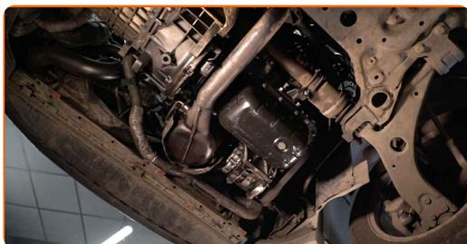
**17** Coloque un contenedor para el aceite de desecho con al menos 5 l de capacidad debajo del orificio de drenaje.
