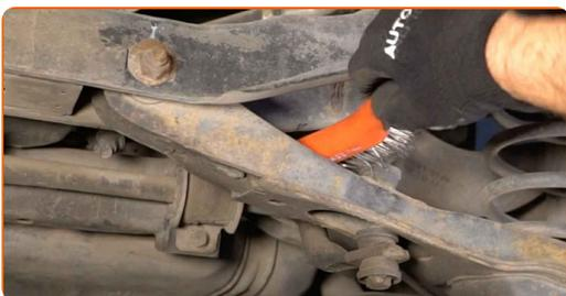
**7** Destornille la fijación de la barra del estabilizador. Use un vaso de impacto del n.º 16. Usa una llave mixta del n.º 15.
