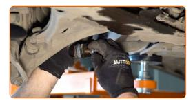
Apriete la sujeción que conecta la bieleta a la barra estabilizadora. Usa una llave mixta del n.º 18. Use un vaso de impacto del n.º 18. Utilice una llave dinamométrica. Apriételo a un par de 60 Nm.
