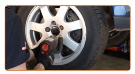
Baje el automóvil y, manteniendo el orden cruzado, apriete los pernos de fijación de las ruedas. Utilice una llave de impacto para llanta # 19. Utilice una llave dinamométrica. Apriételo a un par de 140 Nm.
