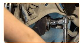
Apriete la sujeción que conecta la bieleta de barra estabilizadora al amortiguador. Usa una llave mixta del n.º 18. Use un vaso de impacto del n.º 18. Utilice una llave dinamométrica. Apriételo a un par de 50 Nm.
