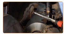
Trate todas las juntas de la bieleta o enlace estabilizador. Use grasa de cobre.
