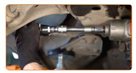
Retire el enlace estabilizador de estabilidad transversal.
