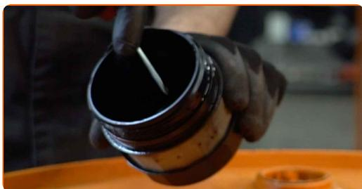
**16** Instale una nueva junta tórica en el asiento de montaje de la cubierta del filtro.
