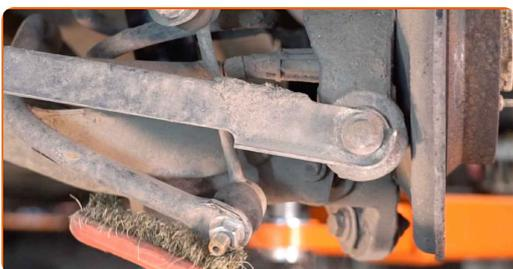
**7** Afloje los sujeciones que conectan la bieleta de barra estabilizadora. Use un vaso de impacto del n.º 18. Utilice una llave de trinquete.
