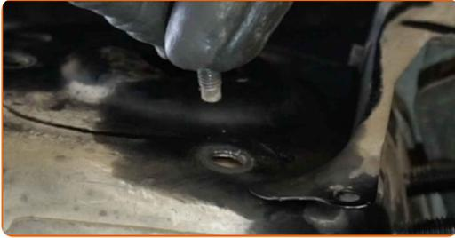
Sustitución: amortiguador telescópico - Volvo V70 BW. AUTODOC recomienda:
