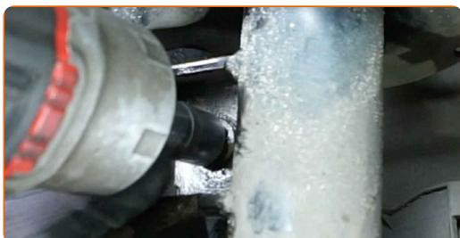
**17** Desconecte la bieleta de la barra estabilizadora del puntal de suspensión.
