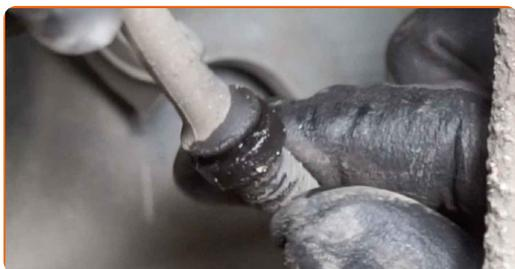
**15** Limpie la sujeción que conecta el enlace de la barra estabilizadora al puntal de suspensión. Use un cepillo de alambre. Use el aerosol WD-40.
