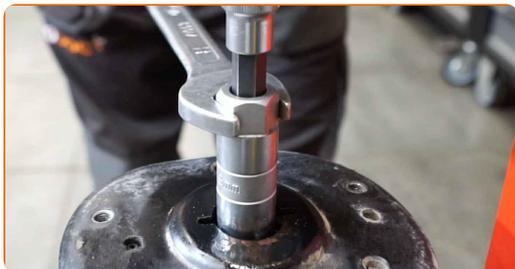
36 Retire el soporte del puntal superior junto con el tope.
