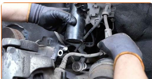
**30** Desatornille las sujeciones superiores del amortiguador.
