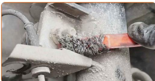
**16** Desatornille la sujeción que conecta la bieleta de barra estabilizadora al amortiguador. Use un vaso de impacto del n.º 15. Utilice una llave de trinquete.
