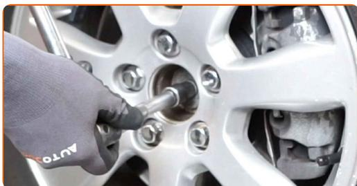
**9** Afloje los pernos de la rueda. Utilice una llave de impacto para llanta # 19. Utilice una llave giramachos.
