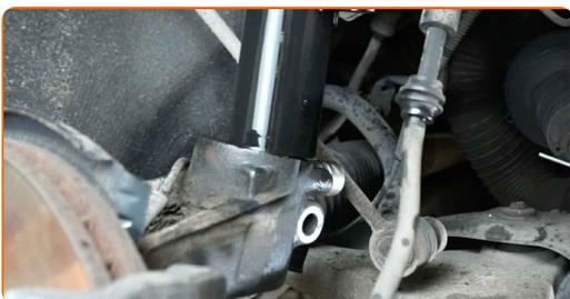
**58** Instale el perno de sujeción.
