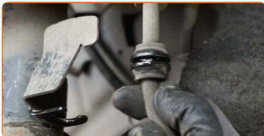
**14** Desconecte el cableado del sensor ABS.
