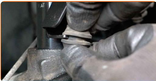
**69** Apriete las sujeciones inferiores del puntal de suspensión. Use un vaso de impacto del n.º 15. Utilice una llave dinamométrica. Apriételo a un par de 110 Nm.
