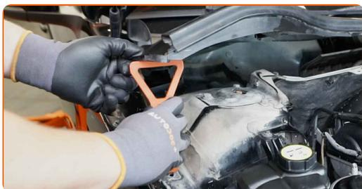
**5** Limpie las sujeciones del soporte superior del puntal amortiguador. Use un cepillo de alambre. Use el aerosol WD-40.
