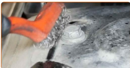
**6** Afloje las sujeciones superiores del puntal de suspensión. Use un vaso de impacto del n.º 13. Utilice una llave de trinquete.
