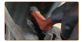
Desenrosque las sujeciones de la pinza de freno. Usa una llave mixta del n.º 15. Use un vaso de impacto del n.º 13. Utilice una llave de trinquete.
