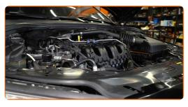
Desatornille el tapón del depósito del líquido de frenos.
