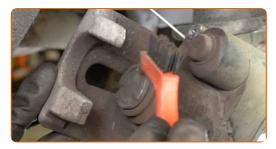
Presione el pistón de la pinza de freno. Utilice la herramienta de retorno del pistón de freno.
