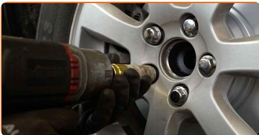
**55** Baje el automóvil y, manteniendo el orden cruzado, apriete los pernos de fijación de las ruedas. Utilice una llave de impacto para llanta # 19. Utilice una llave dinamométrica. Apriételo a un par de 140 Nm.
