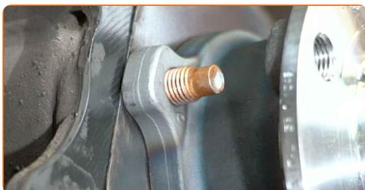
**33** Apriete las sujeciones del cubo de rueda. Utilice Torx T55. Utilice una llave dinamométrica. Apriételo a un par de 110 Nm.
