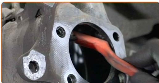
**30** Instale la cubierta del disco de freno.
